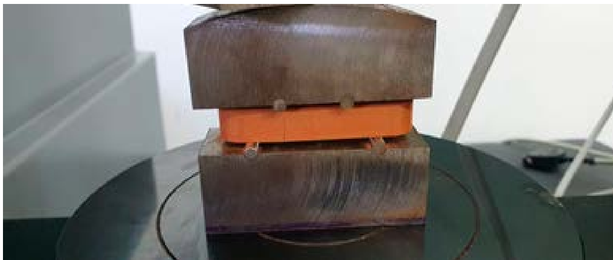
Figura 2 | Dispositivo para ensaio de resistência mecânica por flexão a 4 pontos. No detalhe, ruptura na amostra
