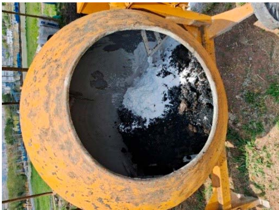
Figura 1 | Mistura entre lodo e cal na betoneira
